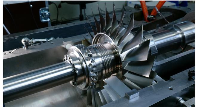
Verdichterblick des einstufigen Verdichters
